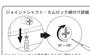
ジョイントシャフトに板を差し込んだら図のように ドライバーでジョイント金具を必ず締め付けてください。 90 度〜180 度までで締め付けてください。180 度以上回すと カムロックが破損しますのでご注意ください。
