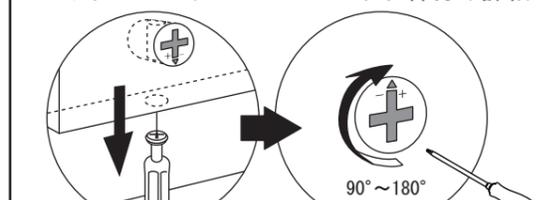
ジョイントシャフトに板を差し込んだら図のようにドライバーでジョイント金具を必ず締め付けてください。90度~180度まで締め付けてください。180度以上回すとカムロックが破損しますのでご注意ください。
