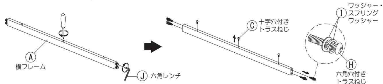
3 (A) 横フレームに (B) 粉受けを組み付けます。
