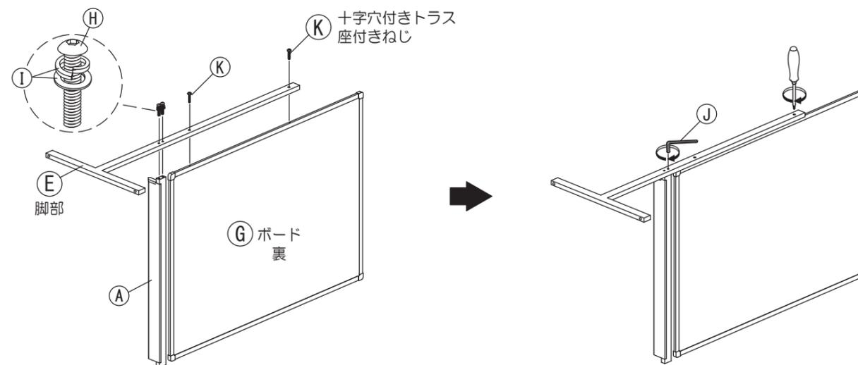
5 反対側にも(E)脚部に2で組み立てた(A)横フレームを(D)六角レンチを使って
