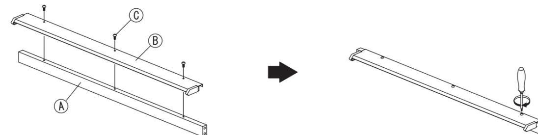
4 (E) 脚部に 3 で組み付けた (A) 横フレームを (J) 六角レンチを使って
