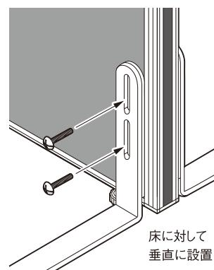
左右のボルトの止め位置は、ボルトを取り付ける際に、左右がぶつからないよう、穴位置をずらしてあります。
